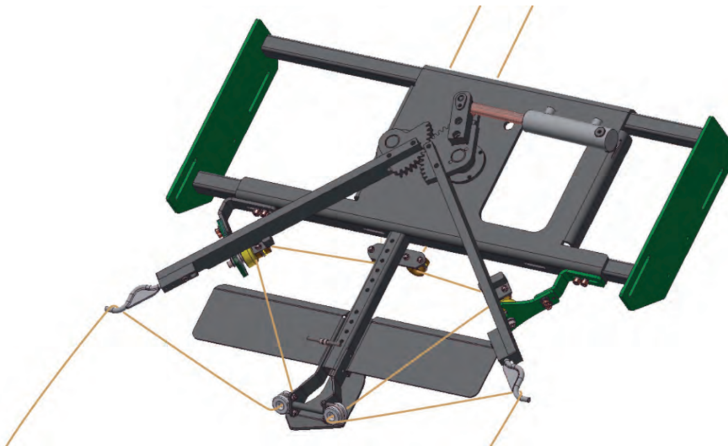
Fig. 32 Système de liage ficelle lors de son fonctionnement ouvert
