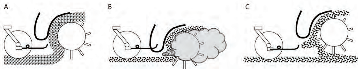
Fig. 72 Réglages possibles de la hauteur du pick-up
