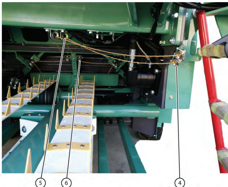
Fig. 48 Amener la ficelle vers le système de liage ficelle
