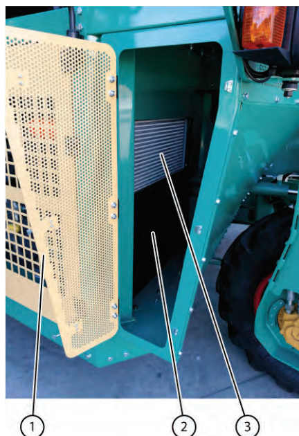
Fig. 98 Nettoyer les radiateurs moteur
