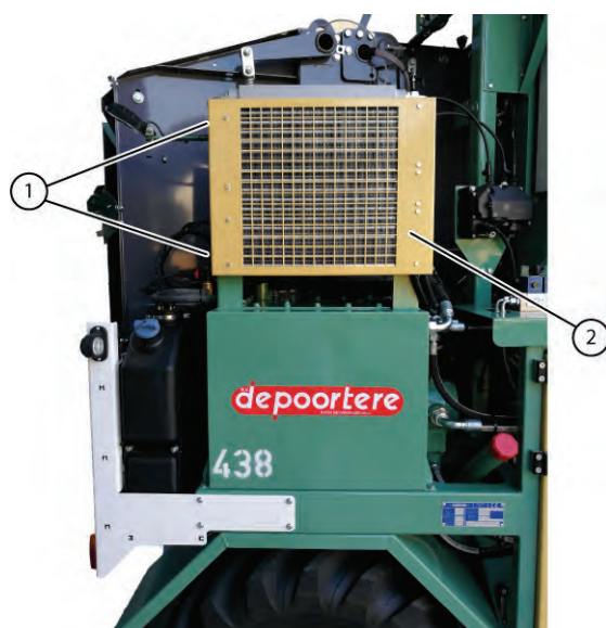
Fig. 99 Nettoyer les radiateurs de la clim et de l'huile hydraulique
