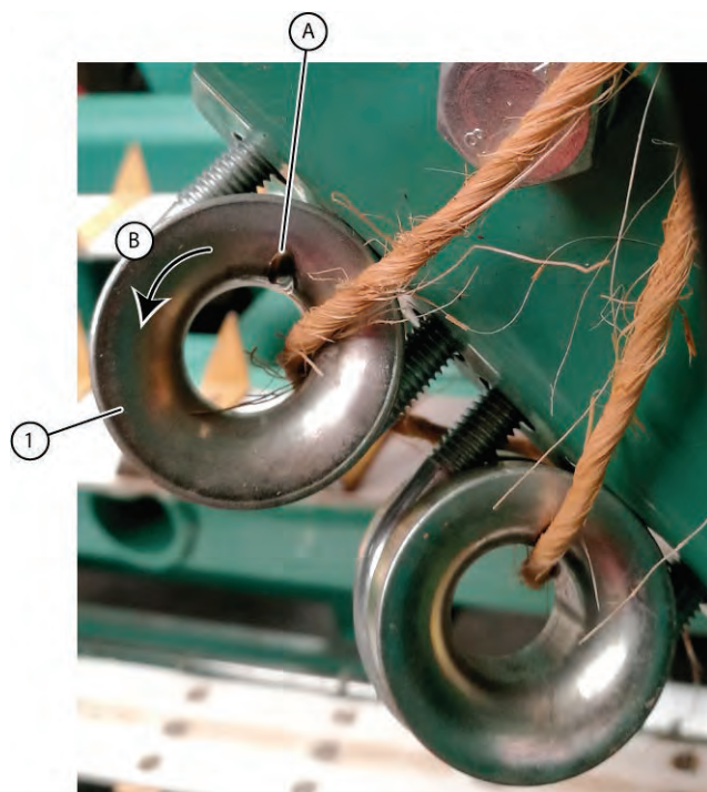
Fig. 109 Usure d'un guide ficelle
